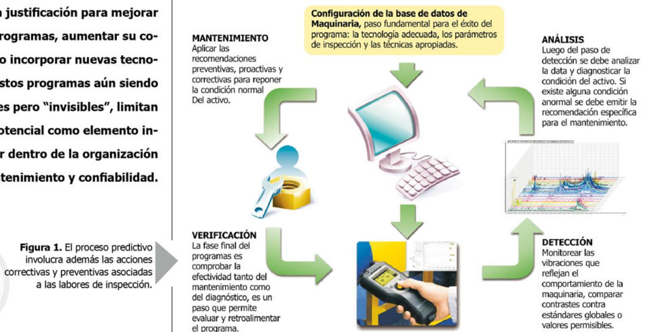
Figura 1. El proceso predictivo involucra además las acciones correctivas y preventivas asociadas a las labores de inspección.
